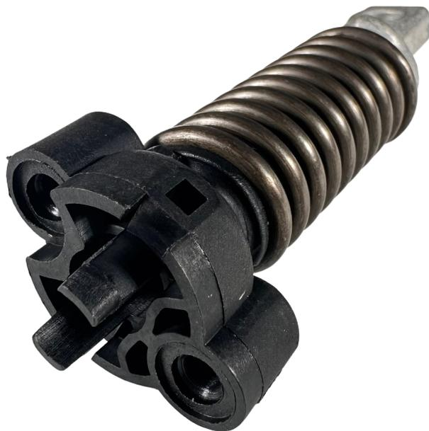
AMORTIGUADOR MANILLAR RAISMAN® PARA MOTOSIERRA STIHL MS361 Descripción: El Amortiguador de Manillar Raisman® para la motosierra STIHL MS361 está diseñado para reducir las vibraciones entre el cuerpo de la motosierra y el manillar. Estas vibraciones, si no se controlan, pueden causar fatiga en el usuario y reducir la precisión al cortar. Características:
